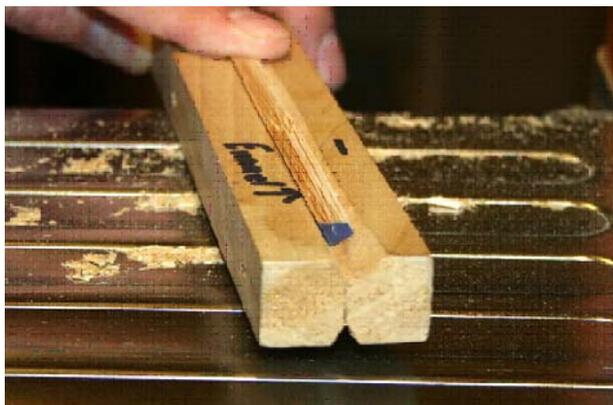
Notare che le lame non toccano la superficie della PF. Non vi è nessuna ragione per fare arrivare le lame a contatto con la PF, come invece si farebbe con la piallatura finale sulla PF. Il solco nelle mie prime e seconde form sono profonde circa .125 " oppure circa la metà della larghezza di una strip splittato.
