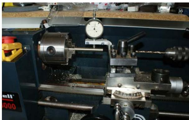
si può usare anche una base magnetica. Appoggio la punta del comparatore sulla superficie cilindrica del pezzo e, facendo ruotare lentamente a mano il mandrino, controllo se il pezzo è centrato: se il comparatore registra variazioni superiori ai 5 centesimi sblocco il pezzo, gli faccio fare una rotazione di pochi gradi, lo ri-blocco e ripeto la misurazione. Ciò fino a quando la rotazione del mandrino mi porta ad avere variazioni non superiori a 5 centesimi di millimetro.
