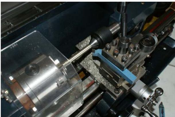
quindi possiamo procedere alla sagomatura e finitura esterna. La porzione rastremata possiamo farla con piccoli gradini (facile) oppure conica (più difficile). Nei piccoli torni non c'è un sistema preciso per misurare in gradi (o frazione di essi) la rotazione della torretta per dobbiamo procedere in modo empirico. Ad esempio per una ghiera di 14/64 con 1,5° si produce la conicità necessaria su 5 mm di ghiera. Finita la sagomatura tagliate il pezzo e la femmina è terminata.
