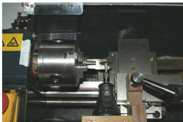
in modo che l'asse di rotazione di questo si alla stessa quota e perpendicolare rispetto a quello del tornio, allineate una ganascia del mandrino ad un riferimento fatto sul telaio del tornio e quindi procedete al taglio con un disco abrasivo dello spessore massimo di 0,5 mm ( nelle rivendite di articoli per odontotecnici ce ne sono anche di più sottili). Ruotate a mano il mandrino
