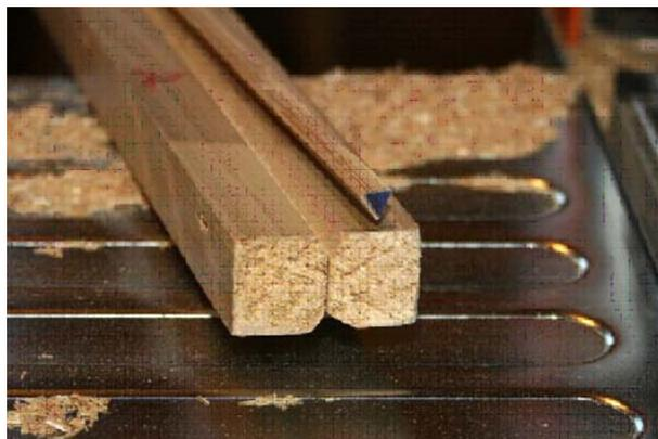
Gli strip sono pronti per il taper. A questo punto lego gli strip e procedo con il trattamento termico prima di procedere al taglio del taper.
