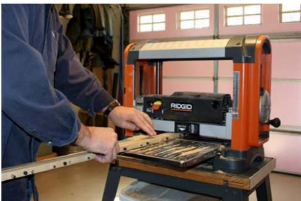
Si eseguono passaggi multipli con la prima strip fermandosi dopo ogni passaggio per controllare il diametro fino a quando si raggiunge quello desiderato. Mi fermo a 80 millesimi sopra le dimensioni finali. L'altezza della piallatrice a questa quota viene annotata per le altre strip. Passare le altre strip con due o tre passaggi fino a quando si raggiunge la quota desiderata.
