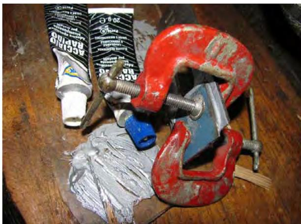
Dopo 24 ore riprovo la lama. Ci sto ancora lavorando. Un unico accorgimento. Quando la lama non è in uso bisogna aprire il galletto di fissaggio.
