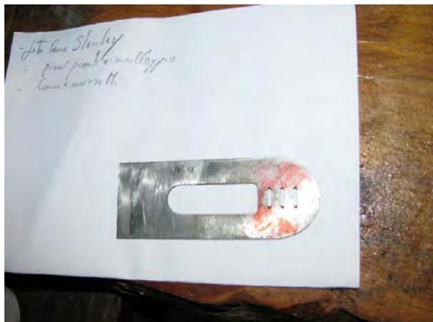
Le operazioni per la realizzazione dovrebbero usare una macchina da taglio a laser o altre tecnologie che non sono nell'officina dietro l'angolo. Si adotta perciò una strategia diversa: si fa un riporto di materiale duro e pregiato usando come base una lama usurata.
