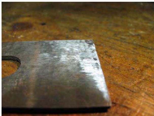
poi provo con un cianoacrilico. L'operazione si conclude in pochi secondi. Il primo test di flessione viene superato. Affilo la lama, la monto, stringo il galletto di vincolo e la lama si scolla! Meglio adesso che su uno strip in fase di finitura. Il cianoacrilico è fragile e si degrada se sottoposto a sollecitazioni termiche anche minime, l'affilatura anche se ben condotta surriscalda il materiale e distrugge questo tipo di colla.
