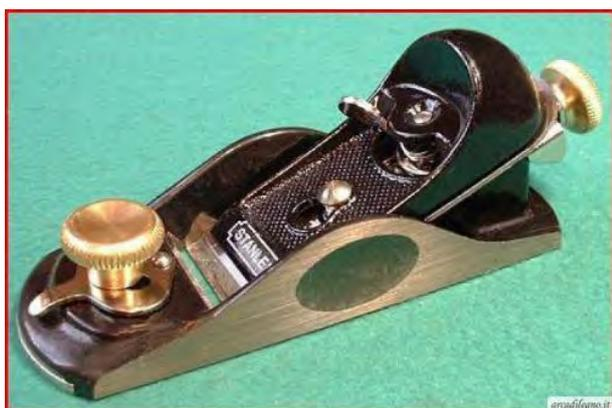
La notevole durezza del legno di B. provoca infatti un veloce deterioramento della lama. La necessità di asportare trucioli di spessore inferiore a 3/100 di millimetro esige invece particolari doti di affilatura.
