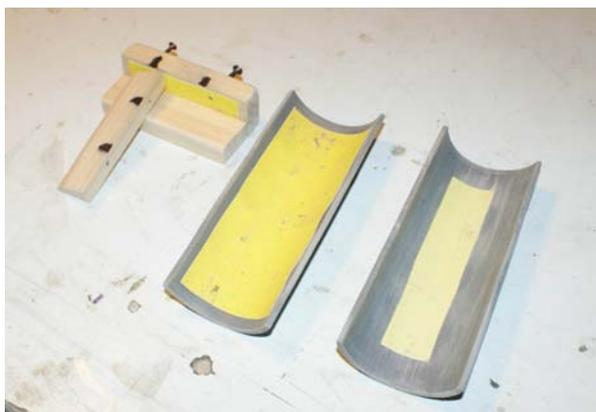
Non eccedete con la grana della carta abrasiva e con l'azione di levigatura. Potete costruirne quattro, uno per ogni grado di curvatura, in modo da rettificare tutti e quattro gli strati di legno.
