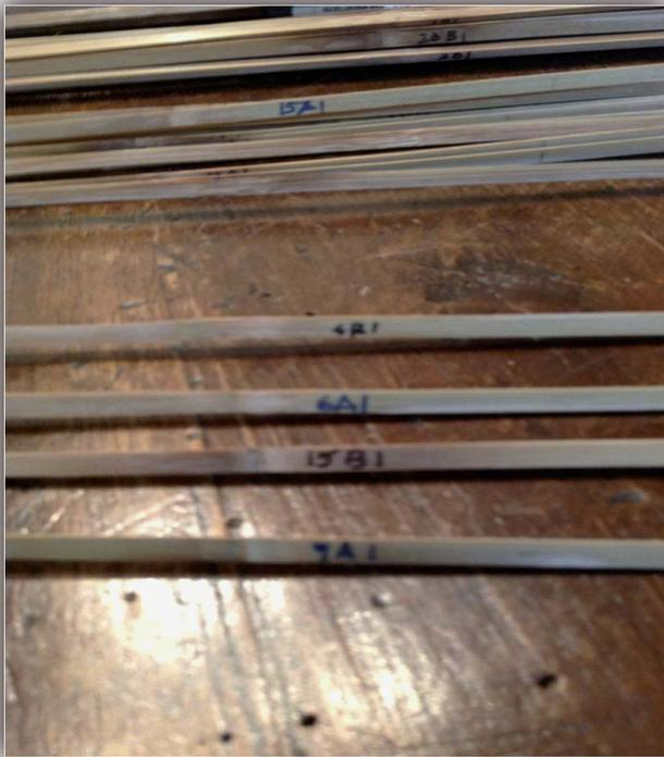
Per cui, ad esempio il provino 24 B 2 si riferisce al nodo più alto del 24° listello della parte bassa del culmo, ed il 9A1 indica il nodo in basso del nono listello della parte alta del culmo.
