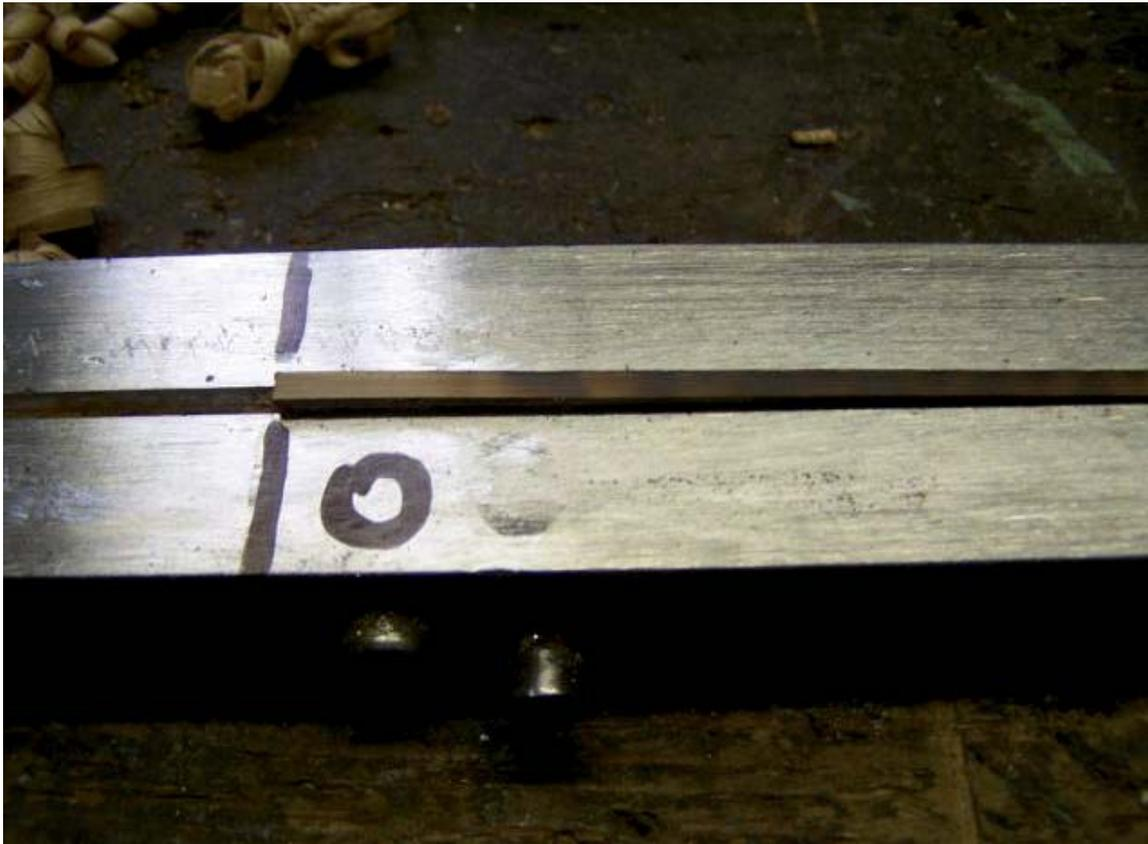
4°) A questo punto utilizzo la seconda regolazione della planning form per portare il listello alla misura finale, piallando le altre facce del listello e rispettando il medesimo procedimento: leggera carteggiatura della parte esterna, rotazione di 1/3 nella planning form, posizionamento spostato di 2 cm rispetto a quello corretto. Quindi piallo l'eccedenza e poi passo il raschietto.
