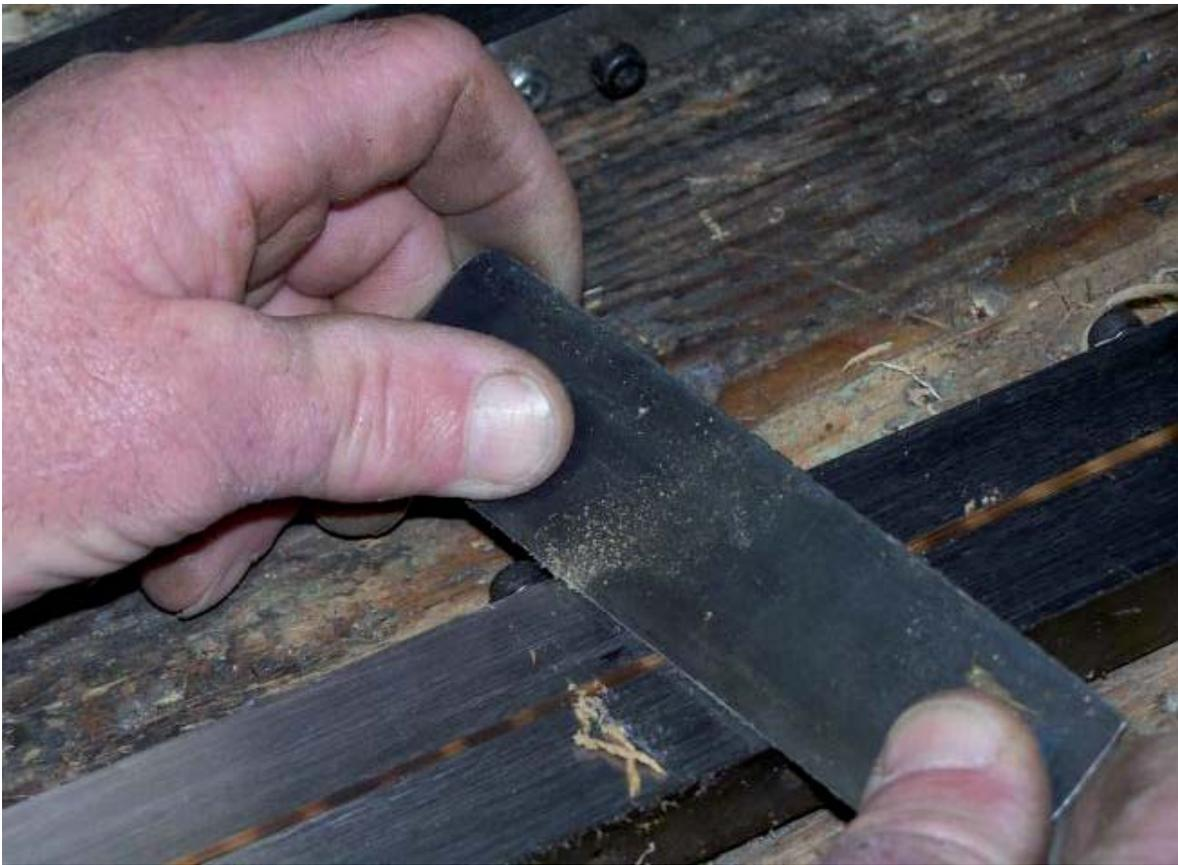
2°) In seguito posiziono il listello effettuando una rotazione di 1/3 delle facce al fine di preservare la parte dura del bamboo. Il listelo è posizionato 2 cm. spostato rispetto alla posizione corretta. Posso iniziare a piallare.
