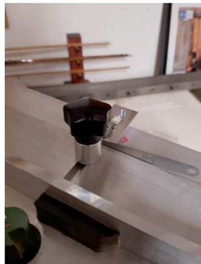
Non è importante che la guida sia perfettamente parallela con il piano in quanto il punto che comanda la profondità della fresata è solo quello che si trova dietro alla fresa.
