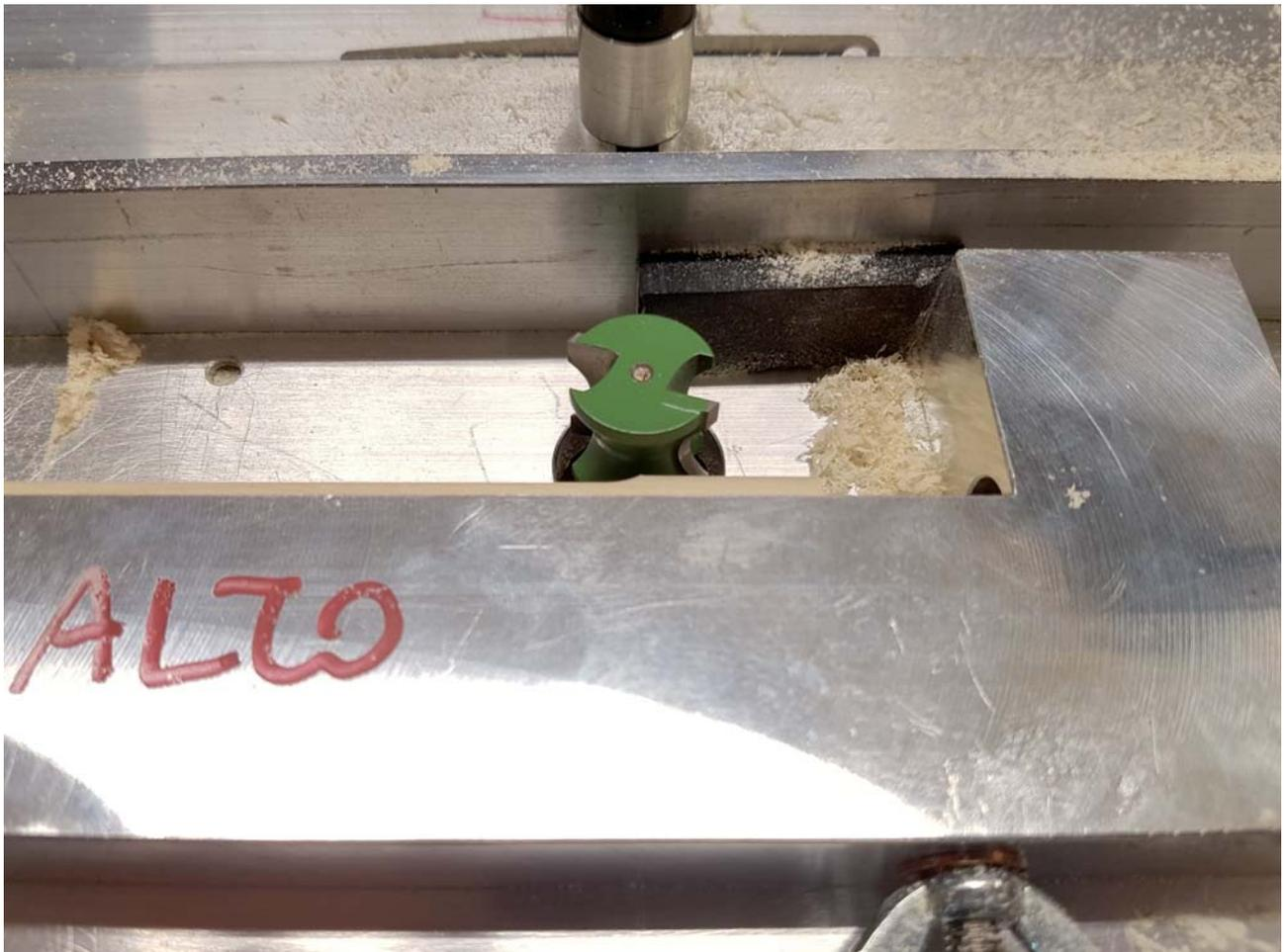
Se blocchiamo il legno sempre nella stessa posizione all'interno della sede (ad esempio sempre bloccato contro la boccola di destra) non sarà importante quanto sia lungo il nostro portamulinello ma la fresata finirà sempre nello stesso punto
