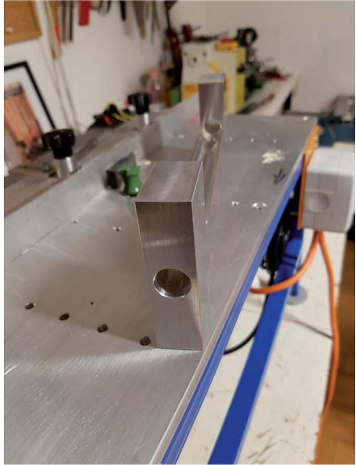
Sulle estremità della sede sono stati realizzati 2 fori passanti nei quali s'infilano due pezzi di barre filettate da 6 mm alle cui estremità sono state saldate 2 bocche con diametro esterno 12 mm.
