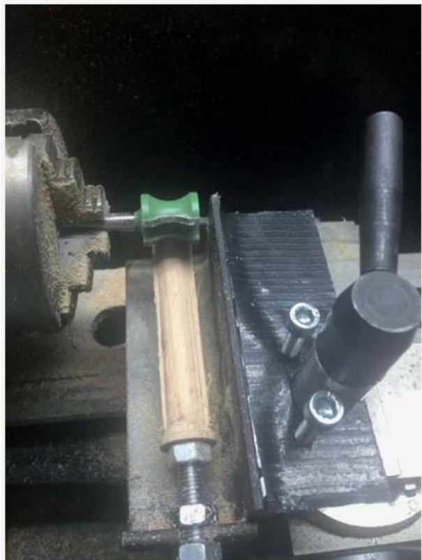
Ora allentando il ferma torretta ed avvitando le due viti a lato la slitta acquisisce il movimento verticale e ci consente di alzare il manichetto verso la fresa e di regolare la profondità delle passate che faremo portando avanti e indietro a nostro piacimento la slitta fino a raggiungere la profondità desiderata.
