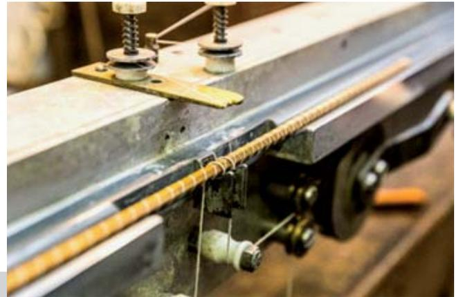
*Il grezzo è trainato da uno spago teso avvolto due volte attorno ad esso. La colla in eccesso viene espulsa in questo processo e si formano giunti permanenti senza soluzione di continuità, creando una solida sezione esagonale.*
