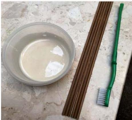
I nostri grezzi vengono incollati con un adesivo urea-melaminico. Usiamo un binder in stile Garrison di nostra produzione. Le sezioni incollate vengono lasciate polimerizzare per due settimane appese in un tubo riscaldato. Vengono quindi raddrizzate a fuoco e pulite solo quando correttamente dritte. Le immagini di accompagnamento vi mostreranno che non facciamo nulla di insolito, ma lavoriamo con molta attenzione e abbiamo fatto molta pratica.
