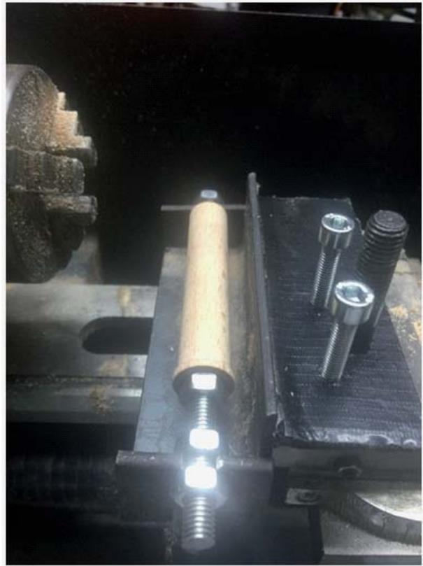
Si monta la fresa e si blocca la slitta con il bullone ferma torretta utilizzando un adeguato spessore per far si che il tutto sia ben fermo
