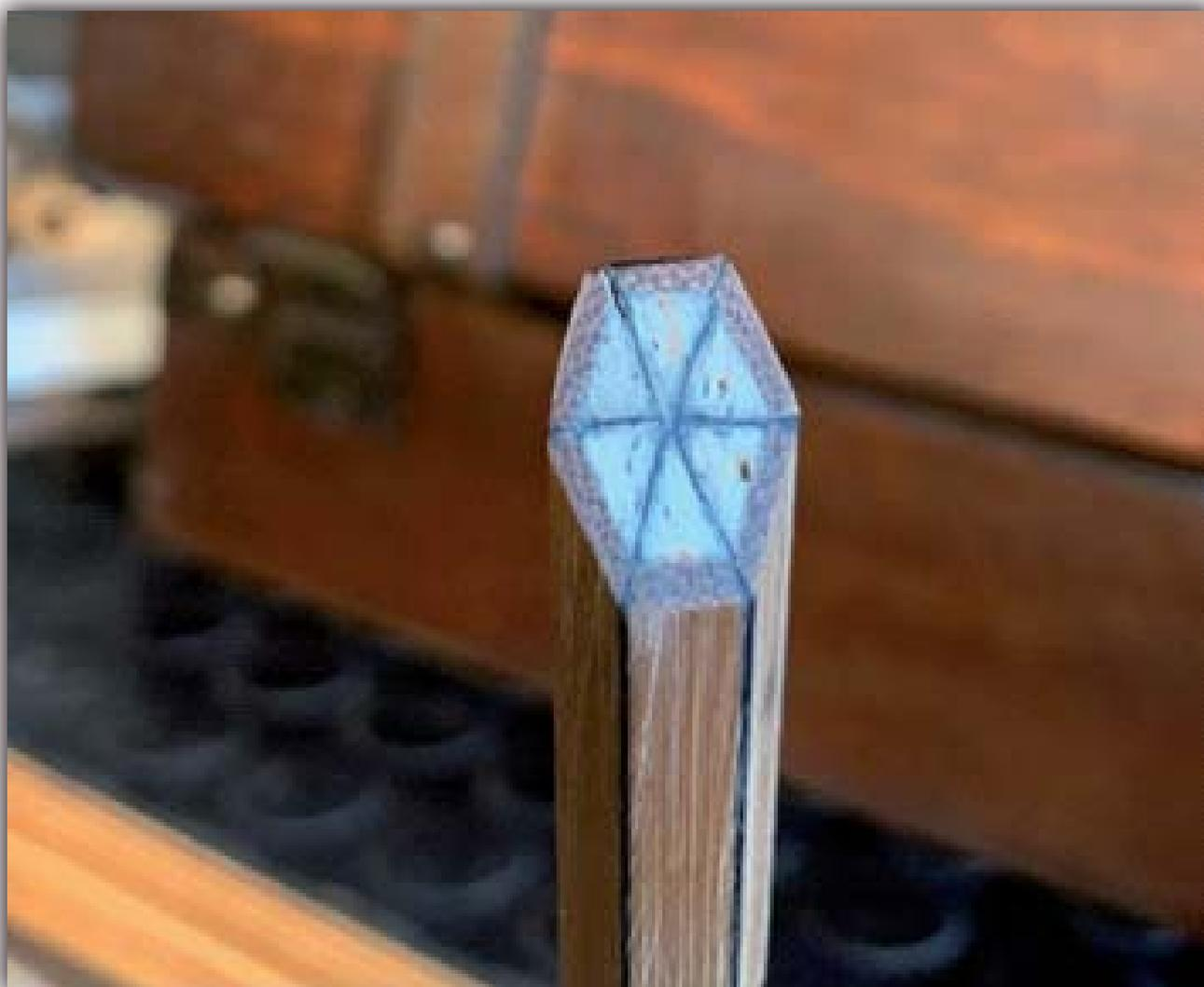
Con la farcitura in balsa ho ottenuto grezzi molto leggeri, ad esempio una 7,2 piedi per coda 4, pesa 35 gr il tallone e 11 gr il cimino, a canna finita il peso si è fissato a 77 gr. Direi un buon risultato in termini di leggerezza senza sacrificare la robustezza garantita dalla stella in carbonio .
