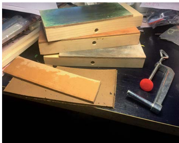
Fig. 7. Alcune tavole da stropping in pelle, due pezzi di cuoio duro ed il morsetto a C per fissarle.
