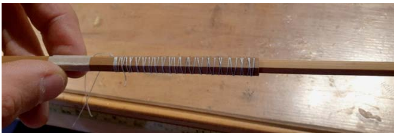
Legatura ferrula esagonale TBF durante incollaggio del tip
