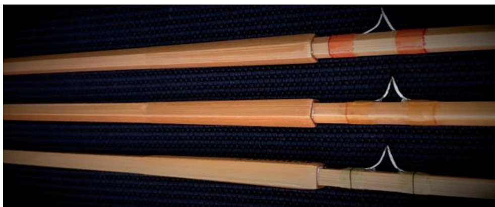
Innesti TBF finiti di canna esagonale, pentagonale e quadrata
