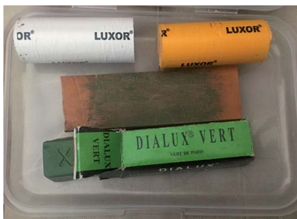
Fig.3. La pasta verde è 0,7 micron (ossido di Cromo), la bianca è 0,3 micron e la gialla è 0,1 micron (ossido di Alluminio).
