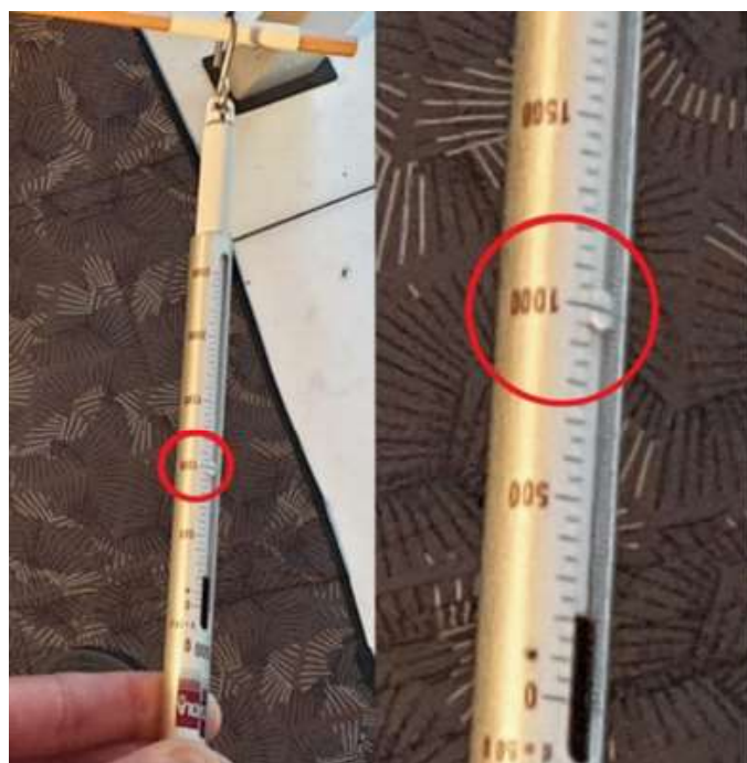
Particolare della lettura del valore di 1kg (2.2lb) sul dinamometro
