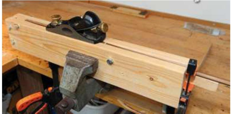
*Dispositivo per mantenere il pezzo grezzo ad angolo per la piallatura delle giunzioni*
