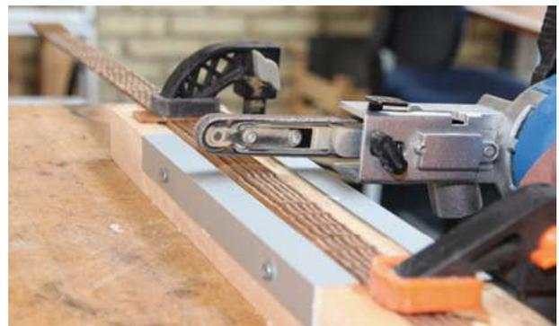
*Dispositivo per controllare la profondità di levigatura in caso di costruzione cava. I Profili in alluminio si rinnovano dopo circa una dozzina di aste poiché anch'essi diventano un po' levigati.*
