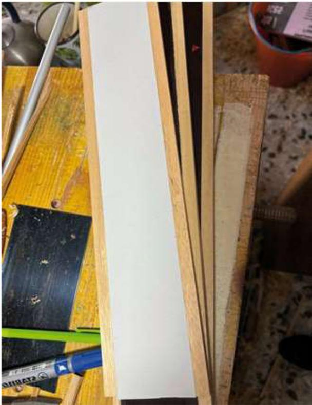
Si noti il piccolo sgarro sullo spigolo della superficie melamminica, dove passa un po' di luce per un piccolo tratto. Ma il filo della riga tocca benissimo simultaneamente sulla lamina melamminica di riferimento e sulla faccia del listello piallato.
