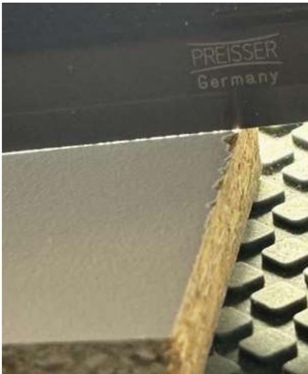
Nella fig. 1.1 il filo di luce è estremamente sottile e granulare a causa del goffratura della superficie. Goffratura che è molto utile perché se la vedete, vuol dire che la lama è proprio a filo, cioè tocca solo sui picchi della goffratura. Un ottimo sistema per stabilire lo zero.
