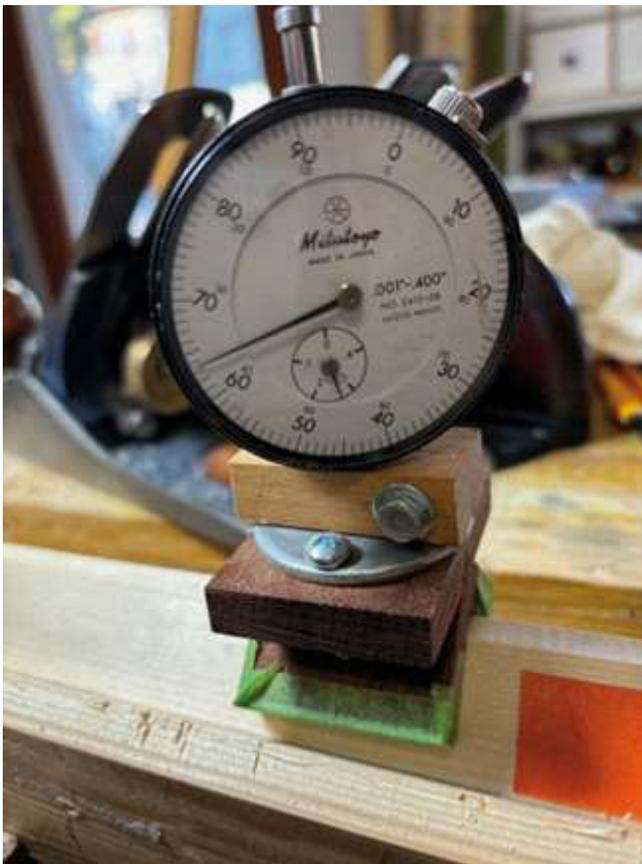
Concludo mostrando la tecnica di misura della profondità di una cava (fig. 4.3). La misura viene eseguita con un comparatore Mitutoyo che palpa la profondità della cava mediante una piccola rotellina che rotola sul fondo dello scavo concavo (non mostrata in figura).
