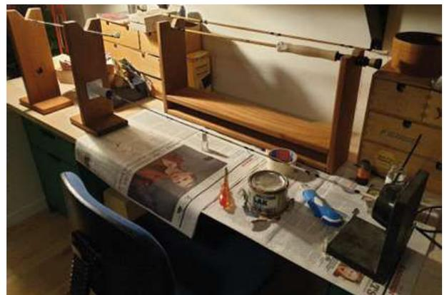
*La guida di verniciatura si avvolge girando lentamente il pezzo grezzo con un motore della griglia/cuscinetto a sfera.*
