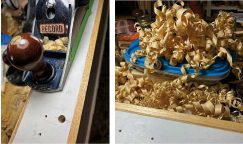
Nella figura 5.7 vediamo una Bailey 4.5 in azione. Notate che durante la piallatura il bordo della suola opposto a quello del bambù viene tenuto in contatto con la superficie melaminica permettendo pertanto una rimozione molto ordinata di listelli tutti dello stesso spessore. Con quattro o cinque piallate togliete 1 mm di spessore! Nella figura 5.8 mostro un insieme di trucioli molto regolari piallati da un listello di obece.
