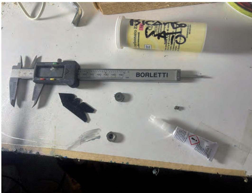
Applico, dalla parte del retro del calibro, due calamite con un piccolo spessore per poi avere il misuratore centrato sulla lama del calibro, verso il fronte del calibro stesso
