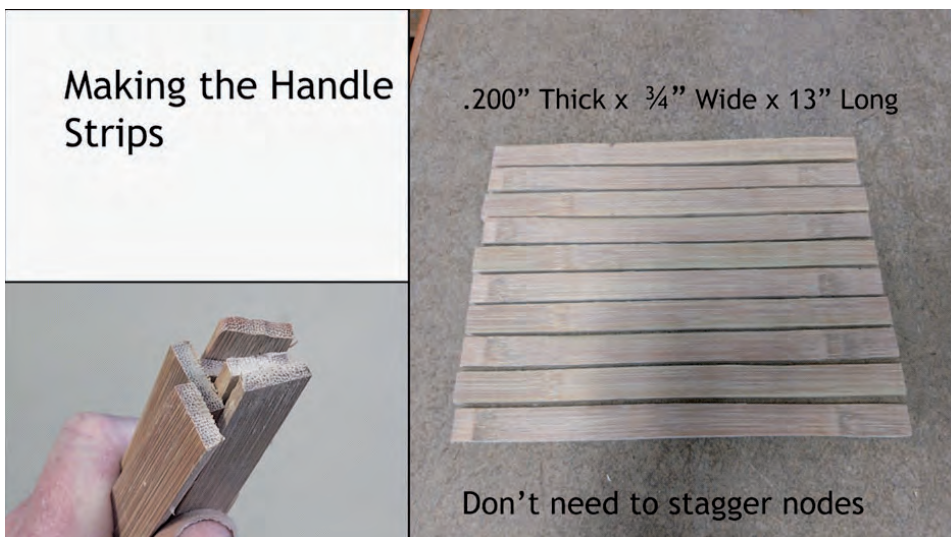
La costruzione degli strips per il manico
