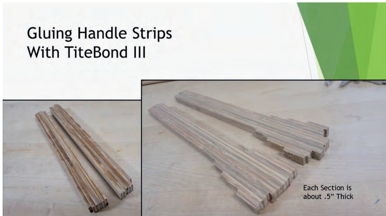
Incollaggio Strips del manico con Titebond III
