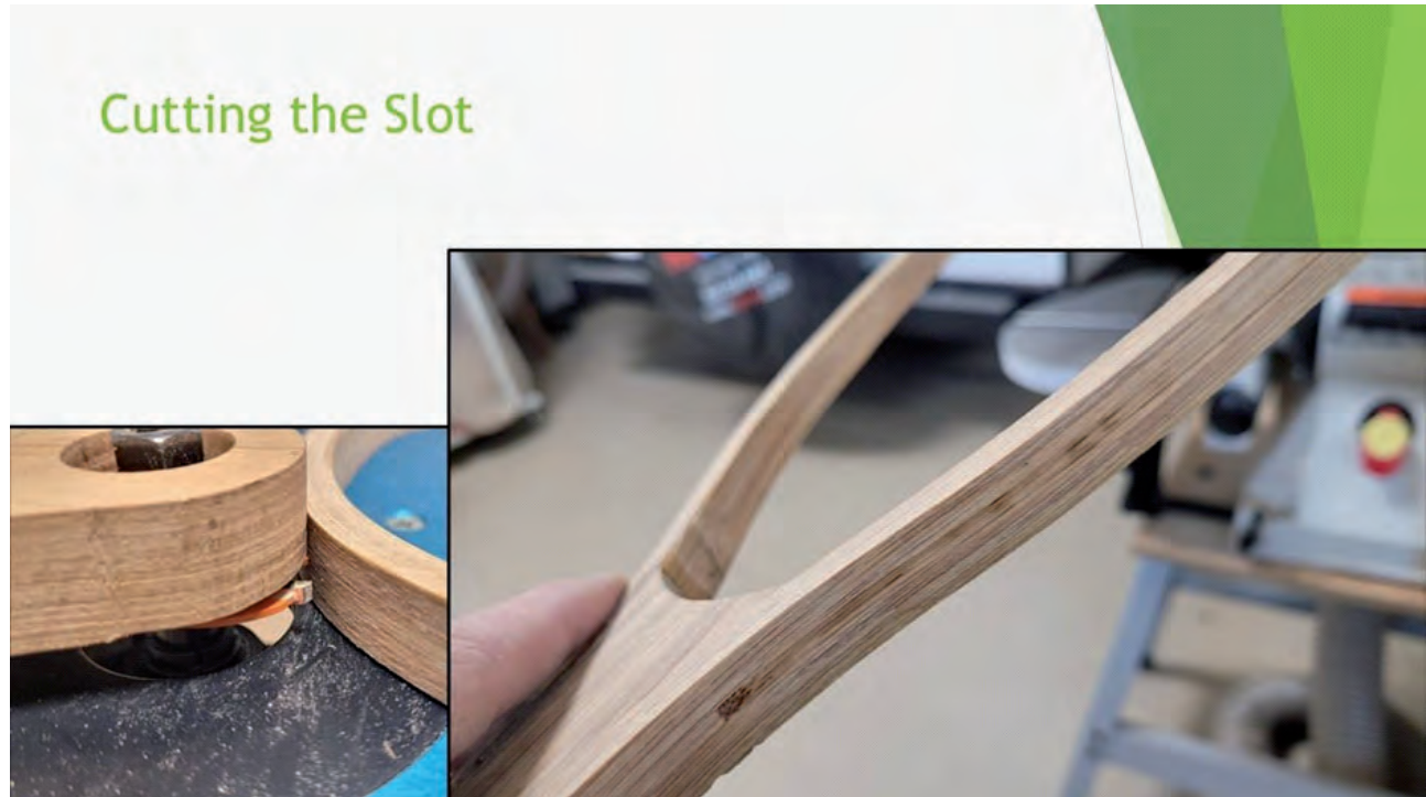
Il taglio della scanalatura per filo di legatura
